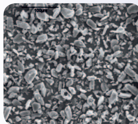
Clinpro™ Prophy Powder • průměrná velikost částice <45 µm • může být použit tolikrát, kolikrát je třeba
